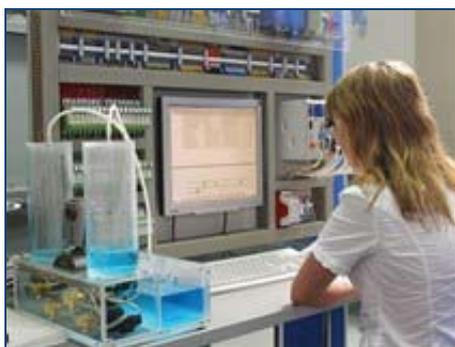
Модель объекта «Резервуарный парк» представляет собой три прозрачных емкости с жидкостью. Две емкости имитируют резервуары, третья - нефтепровод. Емкости соединены между собой трубами, на которых находятся насосы и задвижки. При помощи насосов и задвижек можно осуществлять управление движением жидкости между емкостями. Две резервуарные емкости снабжены датчиками давления, которые позволяют визуально контролировать все процессы управления.
