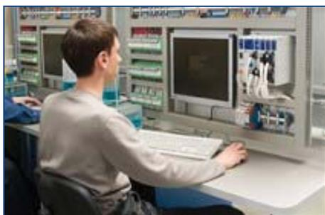
Модель объекта «Физическая тепловая модель» представляет собой нагреваемое тело, управляемый нагреватель, дискретно управляемый вентилятор, в роли охладителя и датчик температуры. При помощи управления вентилятором можно обеспечить заданную температуру тела.
