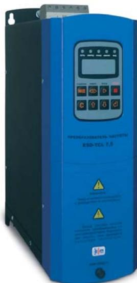
Серия преобразователей частоты (ПЧ) ESD-TCL оптимизирована для применения в составе главного привода грузопассажирских лифтов жилых и административных зданий, и предназначена для управления скоростью вращения и крутящим моментом электродвигателей (ЭД) переменного тока мощностью от 5,5 до 22 кВт.
